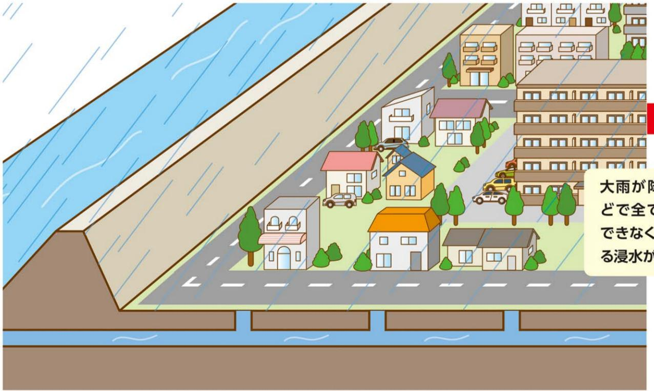
宅地に降った雨は雨水ますへ、道路に降った雨は道路側溝などに集まり、下水道や水路等を通って河川に排水されます。
