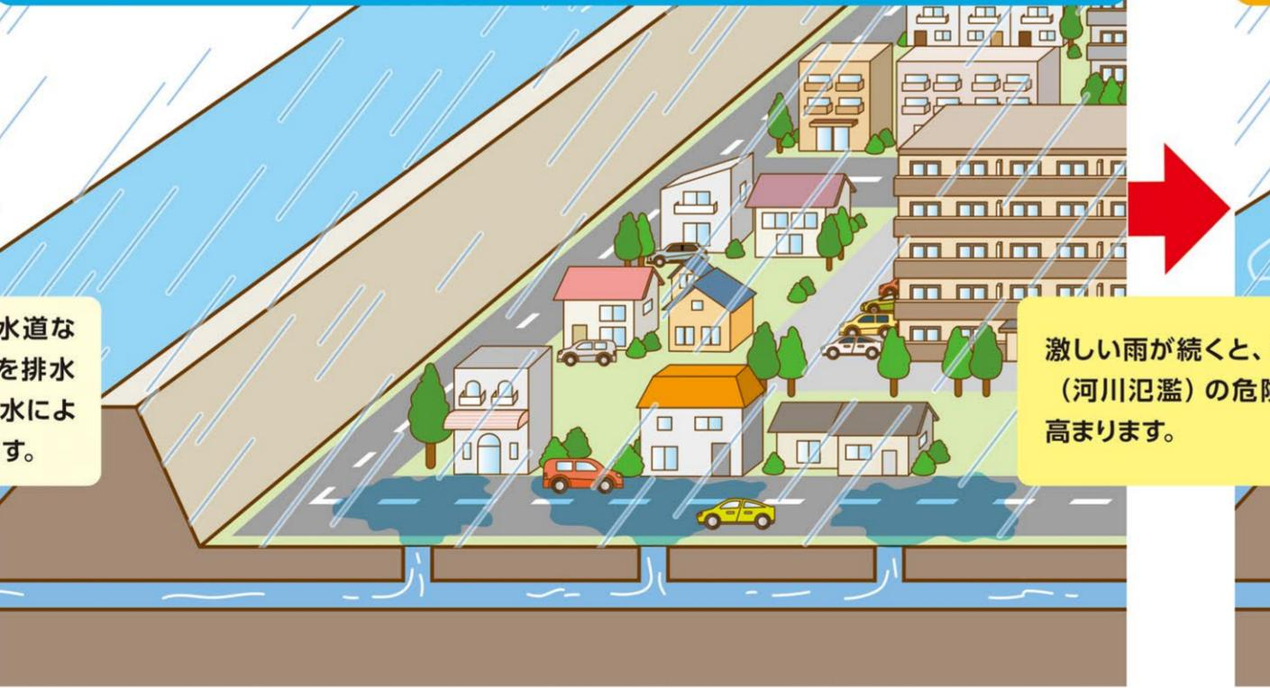
内水氾濫とは、雨の量が下水道などの排水能力を超えたときや、河川などの排水先の水位が高くなったりときに雨水を排水できなくなり、浸水することです。
