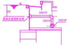
配管断面図 (改修後) S-1/20
