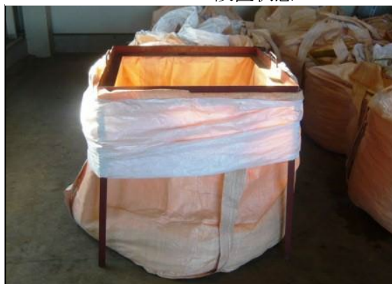
■ フレームのフレコン設置状態
