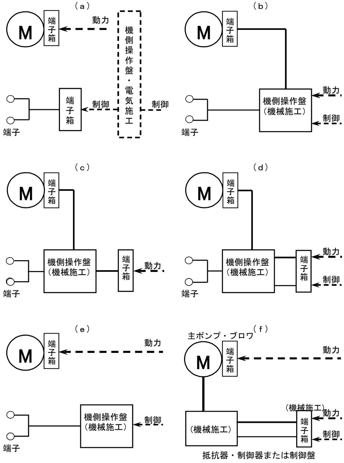
———— は機械設備工事で施工      - - - - - は電気設備工事で施工
