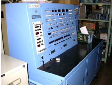
3000形ブレーキ電子機器試験機
