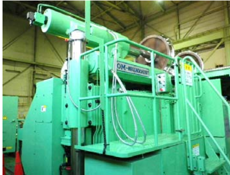
新羽車両基地 車輪転削盤
