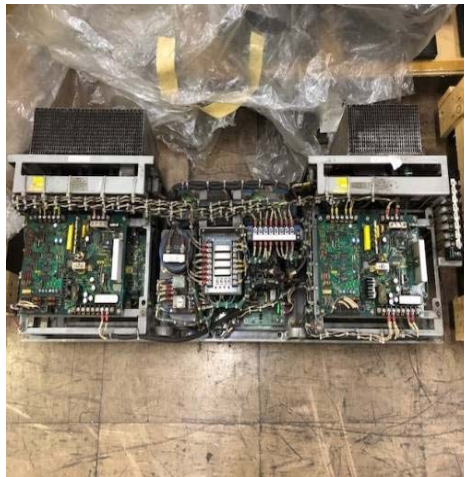
屋根上、冷房インバータユニット (電機品)
