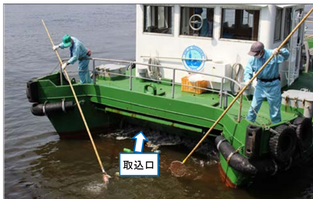
【2つの船体を平行に並べた双胴船（そうどうせん）という海上清掃専用の特殊な船】
