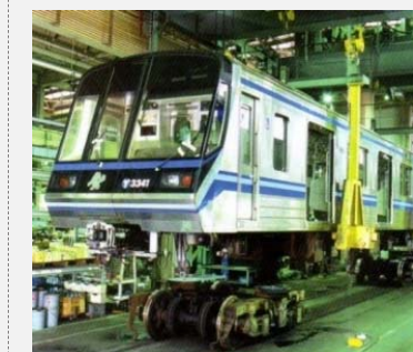
地下鉄車両の点検整備
