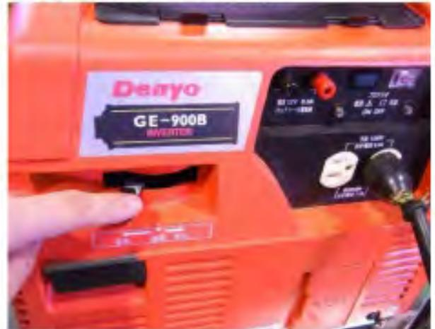
\* 発電機を2分ほど暖気運転し、電動ポンプのコンセントを発電機に差し込んでください。エンジンスイッチを〈運転〉にすると、電動ポンプによる送水が行われます。
