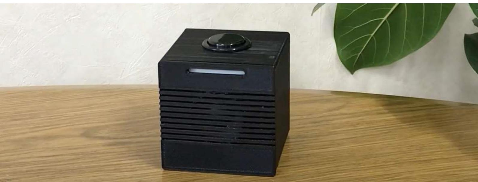
LANケーブルとAC電源を接続するだけで設置でき、「音量調節つまみ」と「聞き直しボタン」のみで操作が簡単です。インターネットを活用したデータの一元管理、一斉配信のシステムです。昨今、情報過多の中、特に**高齢者**の方への的確な情報を配信するために開発した情報受信端末です。
