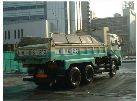
写真 3.3.1-8 荷台にシートを付属した車両
