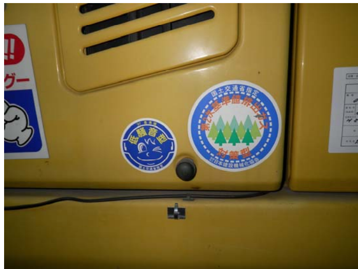
写真 4-5 環境保全のための措置の実施状況（環境対策型建設機械の使用）
