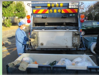
中型車の集合住宅等の機械式のコンテナ収集
