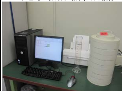
写真3-①-1 水道局の放射性物質測定機器
