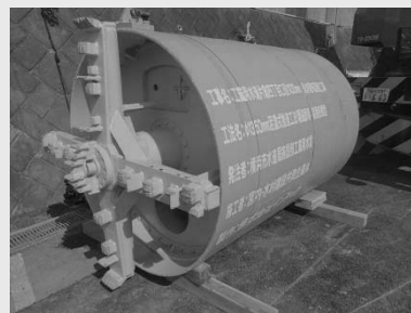
地下にトンネルを掘る機械 （推進機 外径1600mm）
