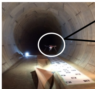
雨水幹線内自動飛行実験
