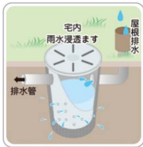
宅内雨水浸透ます
