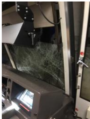
車体前面の窓ガラスが破損
