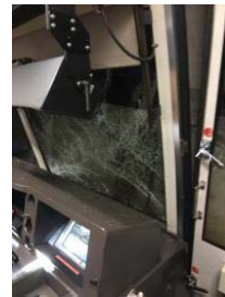
車体前面の窓ガラスが破損
