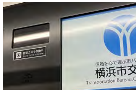
<4000形車両に設置した防犯カメラ>
