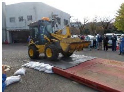
《道路啓開合同訓練(段差の解消訓練)》 横浜建設業協会(旭区会)・旭土木事務所
