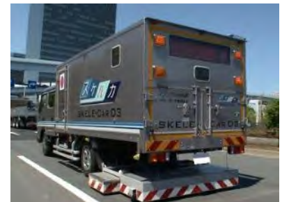
空洞探査車による調査
