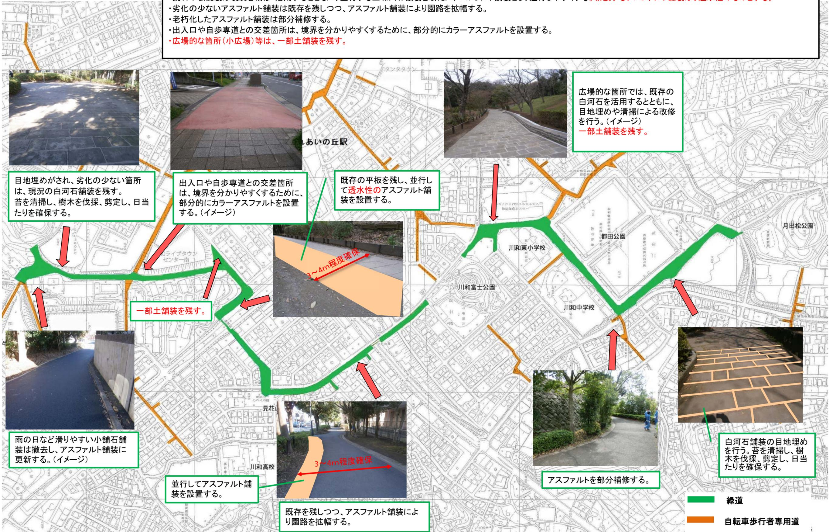
目地埋めがされ、劣化の少ない箇所は、現況の白河石舗装を残す。苔を清掃し、樹木を伐採、剪定し、日当たりを確保する。
